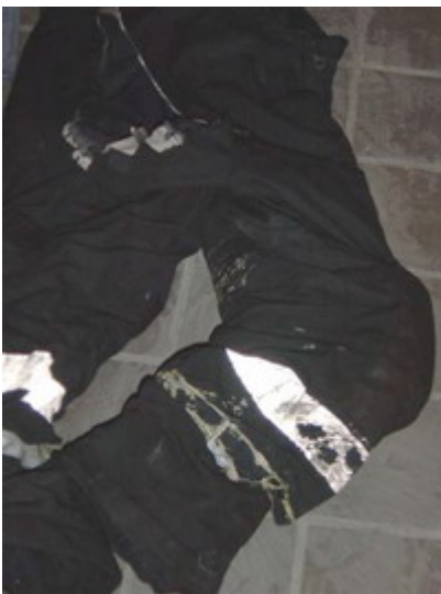
Vom Brand stark belastete Schutzbekleidung, die jedoch weitgehend ihren Träger schützte.
